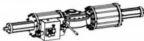
双作用式带手动液压操作机构 Double action manual hydraulic operation structure
